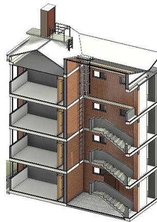
Punto fijo - Acceso a cubierta
