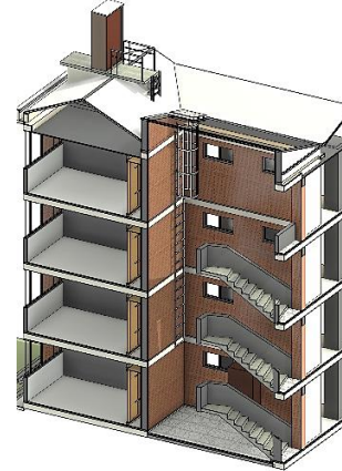
PUNTO FIJO - ACCESO A CUBIERTA
